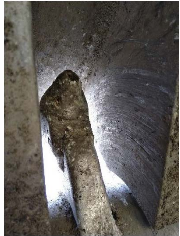
写真5 超硬チップの欠落
