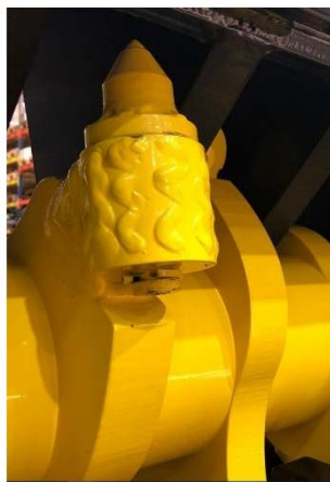
写真7 サークリップで固定されたインサート
