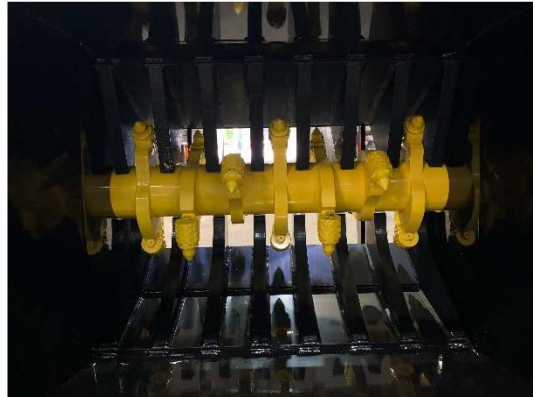
写真4 カウンターブレード付きローターAssy
