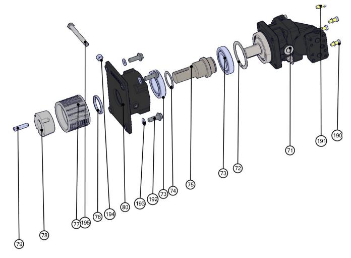
7R-6 Motor and Bearing Assembly-モーターおよびベアリング
