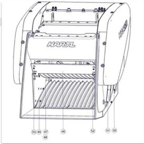
図 12.4: スペアパーツ - 磨耗したハードプレート
