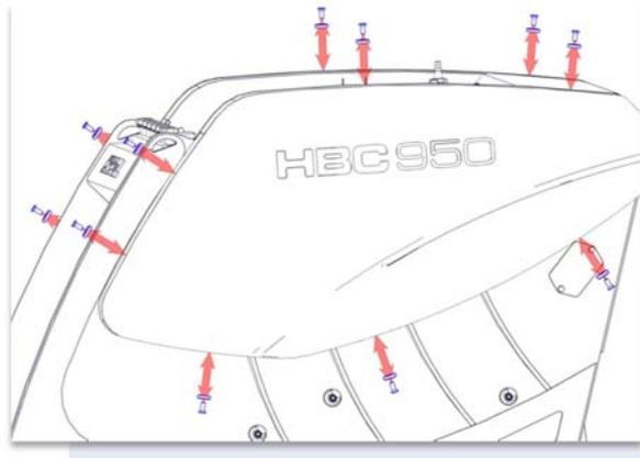
図 10.36: ベルトの張力: ガードを取り外します。
