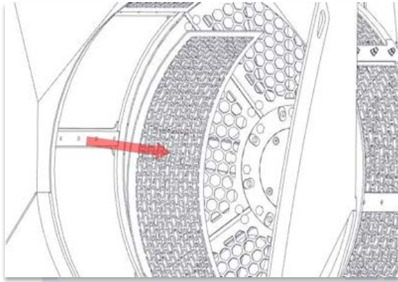
図 10.14.:スクリーナードラムサイドパネル HBS1200/1600: スクリーナープレートを交換しま す。
